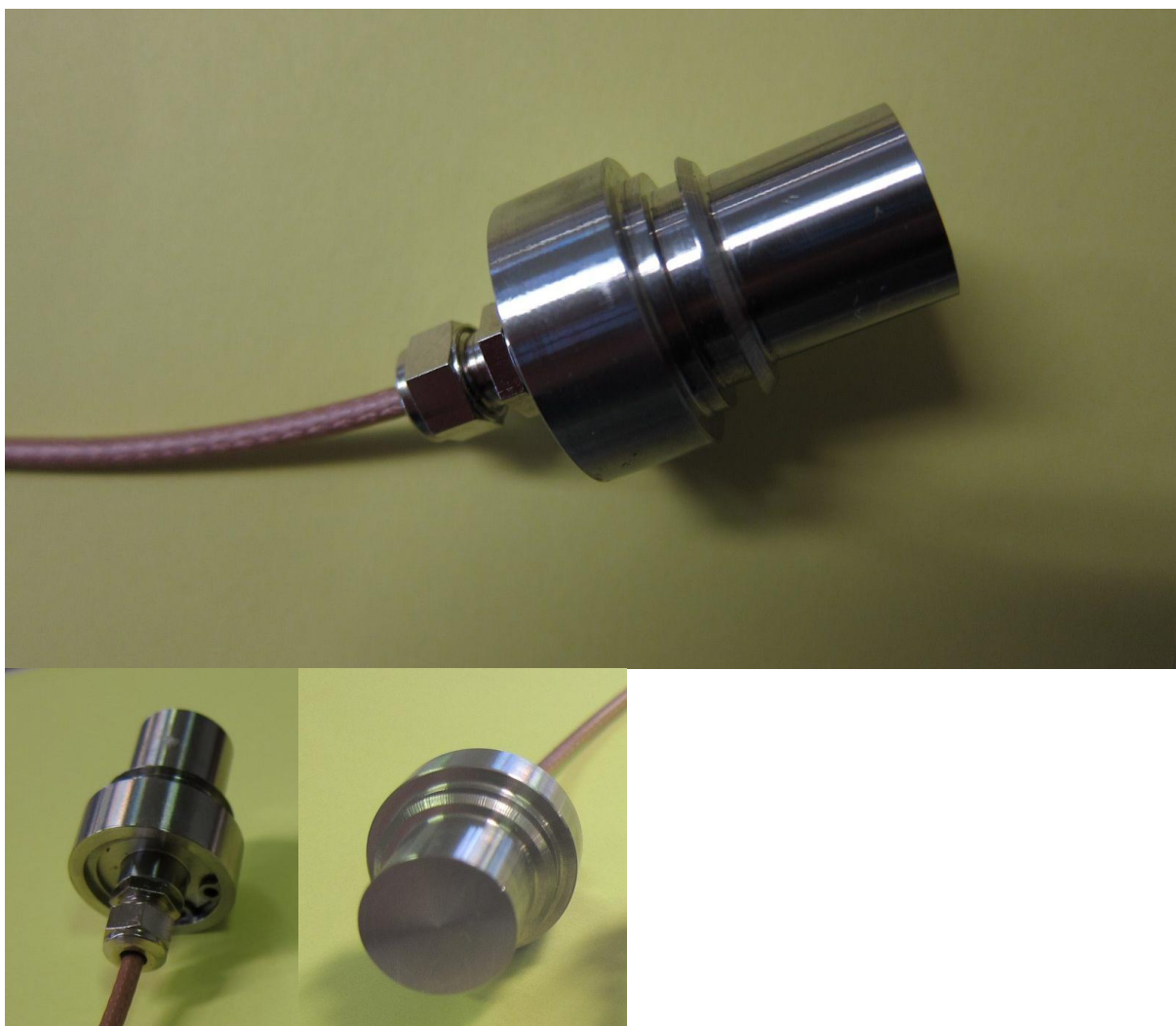
Obr. 1: Vyrobený funkční vzorek ultrazvukové sondy US 10.1
